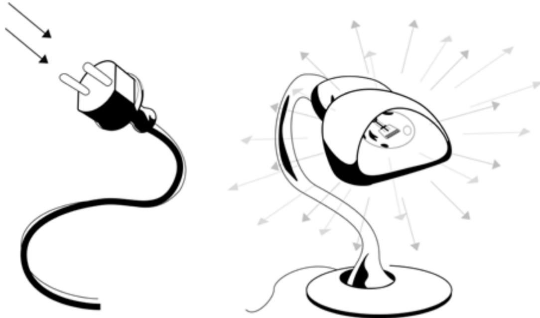
$$\text{Die Lichtausbeute} = \frac{\text{Lichtstrom}}{\text{elektr. Leistung}} = \frac{\Phi}{P} \text{ lm/W}$$
