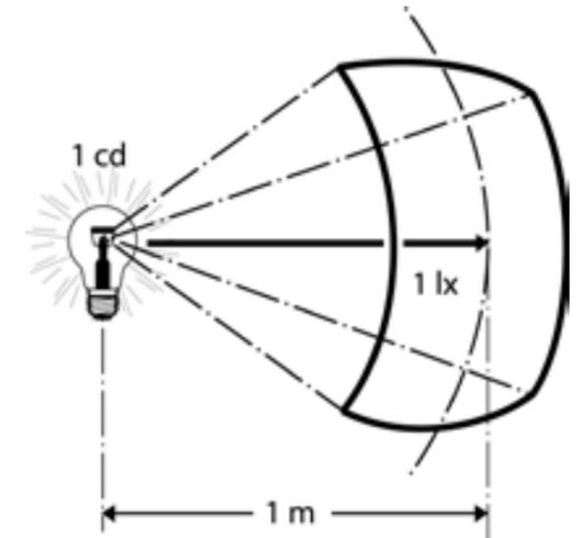
Wenn der Abstand dieser Lichtquelle vergrößert wird, dann nimmt die Beleuchtungsstärke schnell ab, und zwar zum Quadrat der Entfernung. Denn je größer der Abstand von der Lichtquelle wird, desto größer wird auch das Volumen, dass in der Lichtkugel auszufüllen sein wird.
