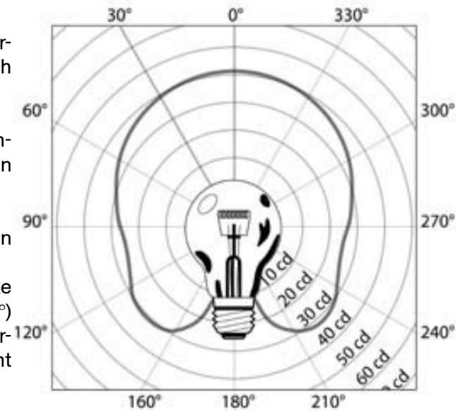
Setzt man der Lampe einen lichtabschirmende Holzspiegel auf, so wird die ursprüngliche Lichtverteilungskurve wesentlich geändert. Der Hauptlichtstrahl wird jetzt nach  $45^\circ$  nach oben gebündelt.
